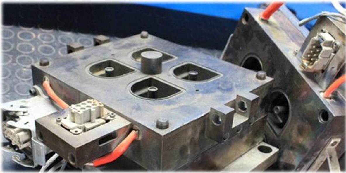
Unsere Pressen lassen sich optional direkt durch Anbringen eines Heizelements an die Form beheizen. Die Presse überwacht automatisch die Temperatur des Heizelements und der Form und gewährleistet so ein optimales Produkt.
