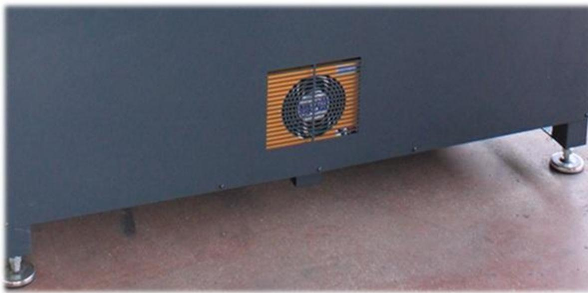
Dank der Ölkühleinheit in unseren Pressen kühlt die Maschine das Hydrauliköl automatisch, wenn die Temperatur den von Ihnen festgelegten Wert überschreitet. Dadurch entstehen keine Leistungsverluste und die Lebensdauer Ihrer Filze wird verlängert.
