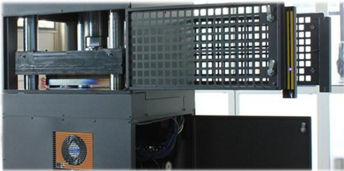
Die zu öffnenden Abdeckungen und der große Säulenabstand unserer Maschinen erleichtern das Anbringen und Abnehmen von Formen. Hydraulikaggregat und Schaltschrank sind durch Öffnen der Abdeckungen leicht zugänglich. Für Service- und Wartungsarbeiten ermöglichen einfache abnehmbare Serviceplatten den Zugang zu jeder Stelle innerhalb weniger Minuten.
