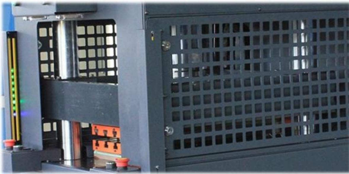
Durch die Lichtschranke an unseren Druckmaschinen werden mögliche Arbeitsunfälle verhindert.
