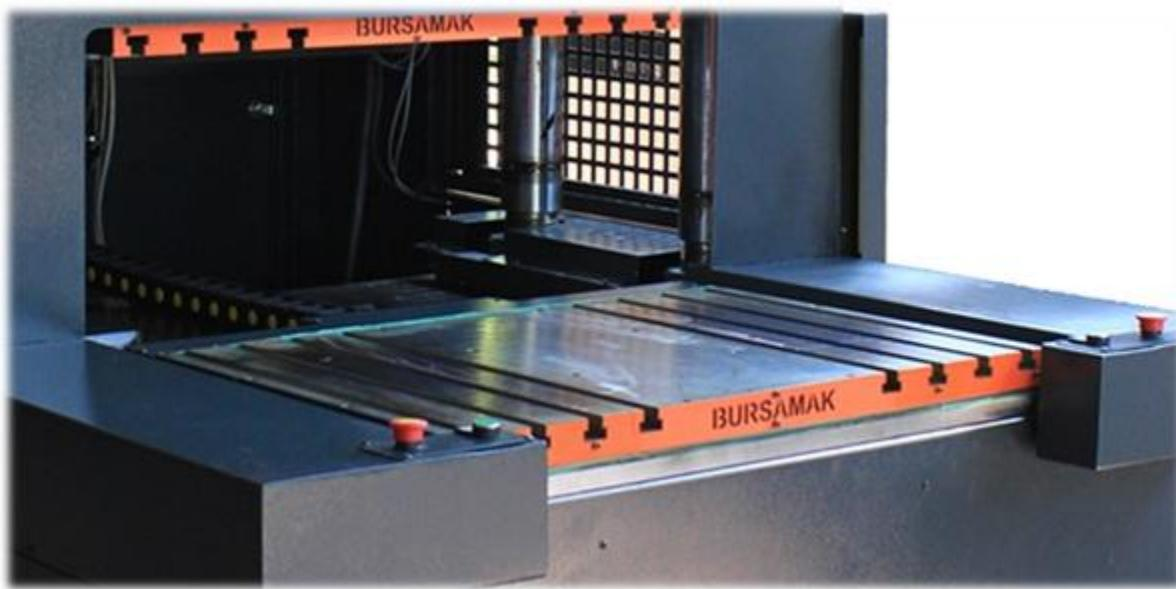
Der hydraulisch verschiebbare Untertisch bringt die Form vor den Bediener und erleichtert so das Be- und Entladen. Da der Obertisch nicht so weit angehoben werden muss und der Bediener leichter arbeiten kann, verkürzt sich Ihre Produktionszeit deutlich.
